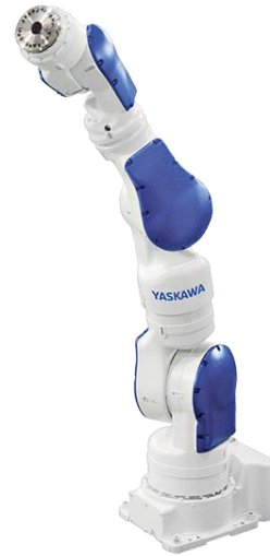
Figura 6. Robot articulado redundante Fuente: Yaskawa Motoman Robotics
