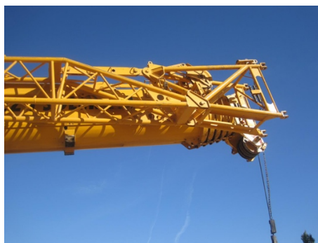
Figura 27: Anclajes de la celosía
