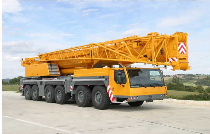
Figura 8: Grúa telescópica autopropulsada. (Camión grúa)
