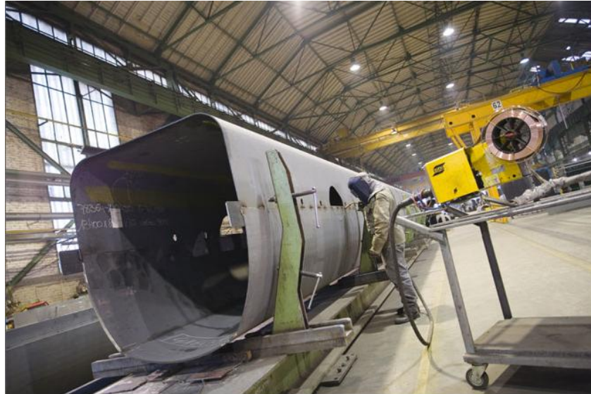
Figura 20: Soldado de una pluma mediante arco sumergido
