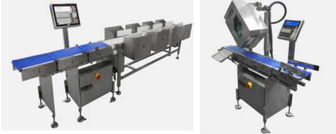
Imagen 5. Distintos tipos de balanzas industriales. A la izquierda el modelo GW4000+, clasificadora por peso. A la derecha una etiquetadora con cabezal inclinable
