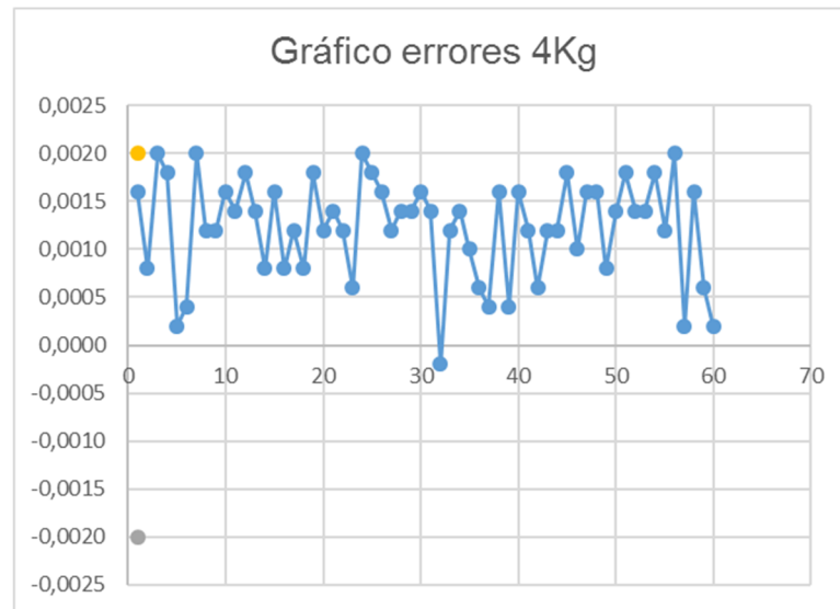
Gráfico A- 1. Representación de los errores de pesaje en cada pesada, con discos de 4 Kg a velocidad 2
