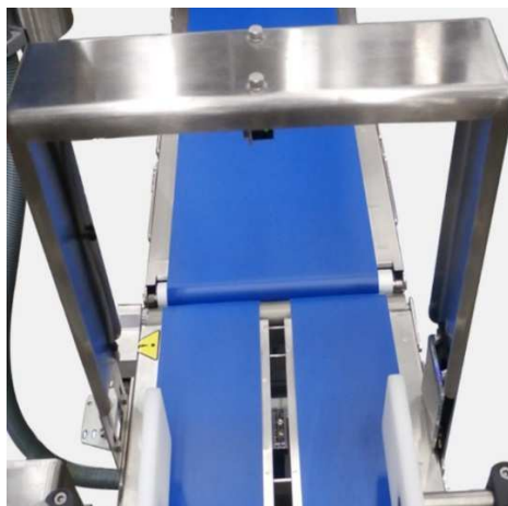
Imagen 6. Detalle cinta de alimentación y seguimiento, la célula de pesaje
