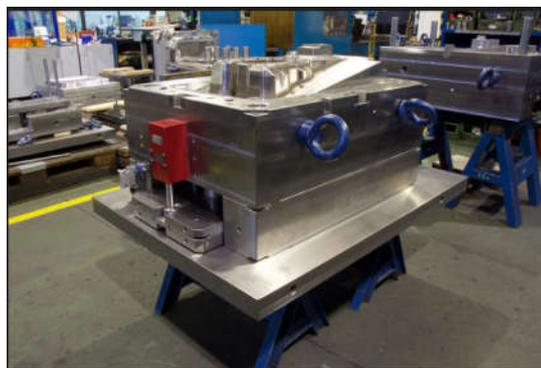
*Figura 2. Molde con cáncamos*
