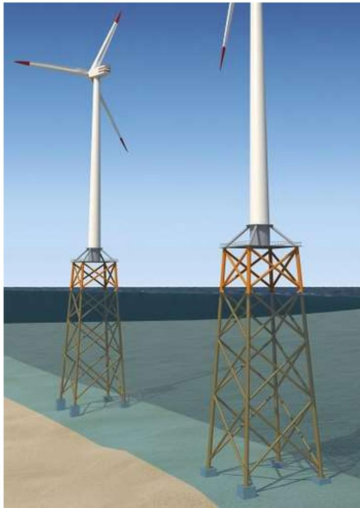
Figura 7-3. Estructura fija tipo Jacket
