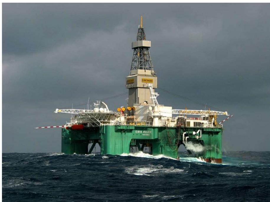
Figura 7-6. Plataforma semi sumergible
