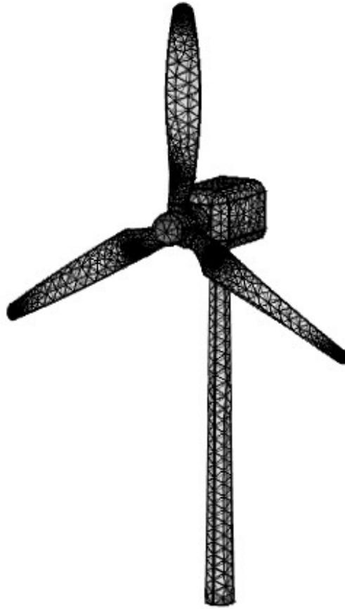
Figura 8-4. Mallado del aerogenerador
