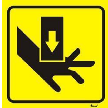
Imagen 1. Riesgo por aplastamiento
