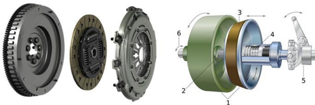
Imagen 5. desmontaje de un embrague
