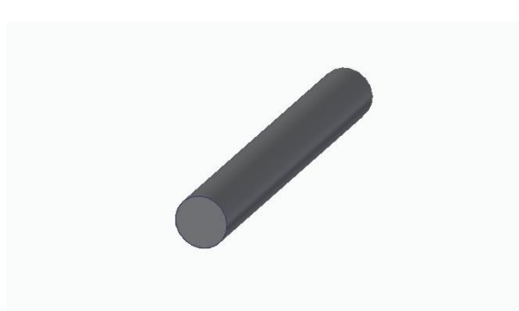
Figura 34. Masa puntual (Simplificación del sistema tornillo + arandelas + tuerca)
