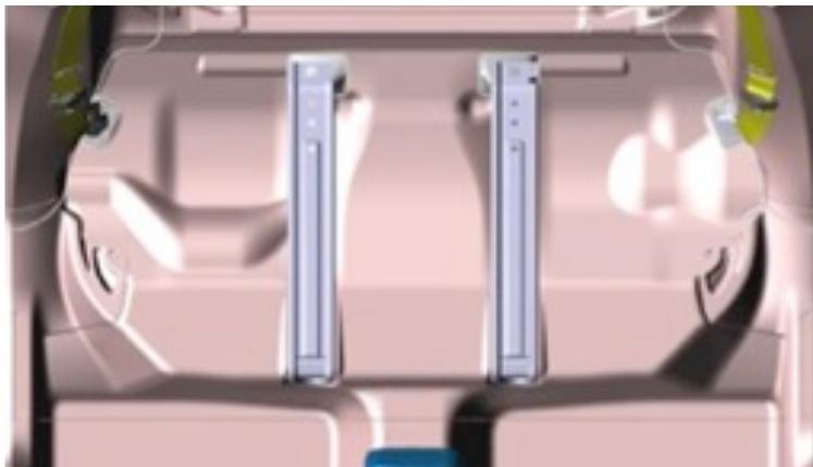
Imagen 8. Carriles del asiento colocados en la carrocería del vehículo – Vista alzado
