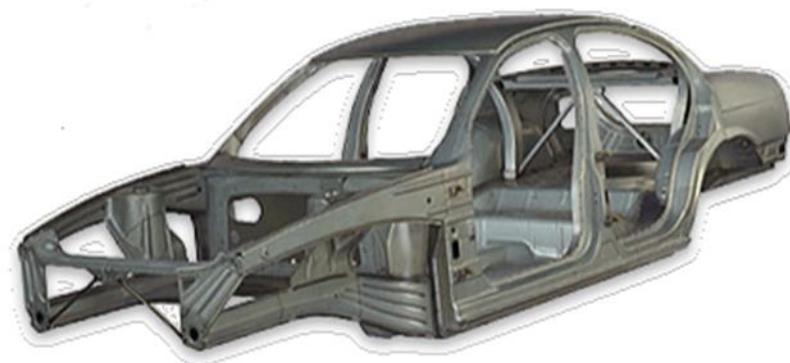
Ilustración 1: Partes del vehículo obtenidas por conformado de chapa
