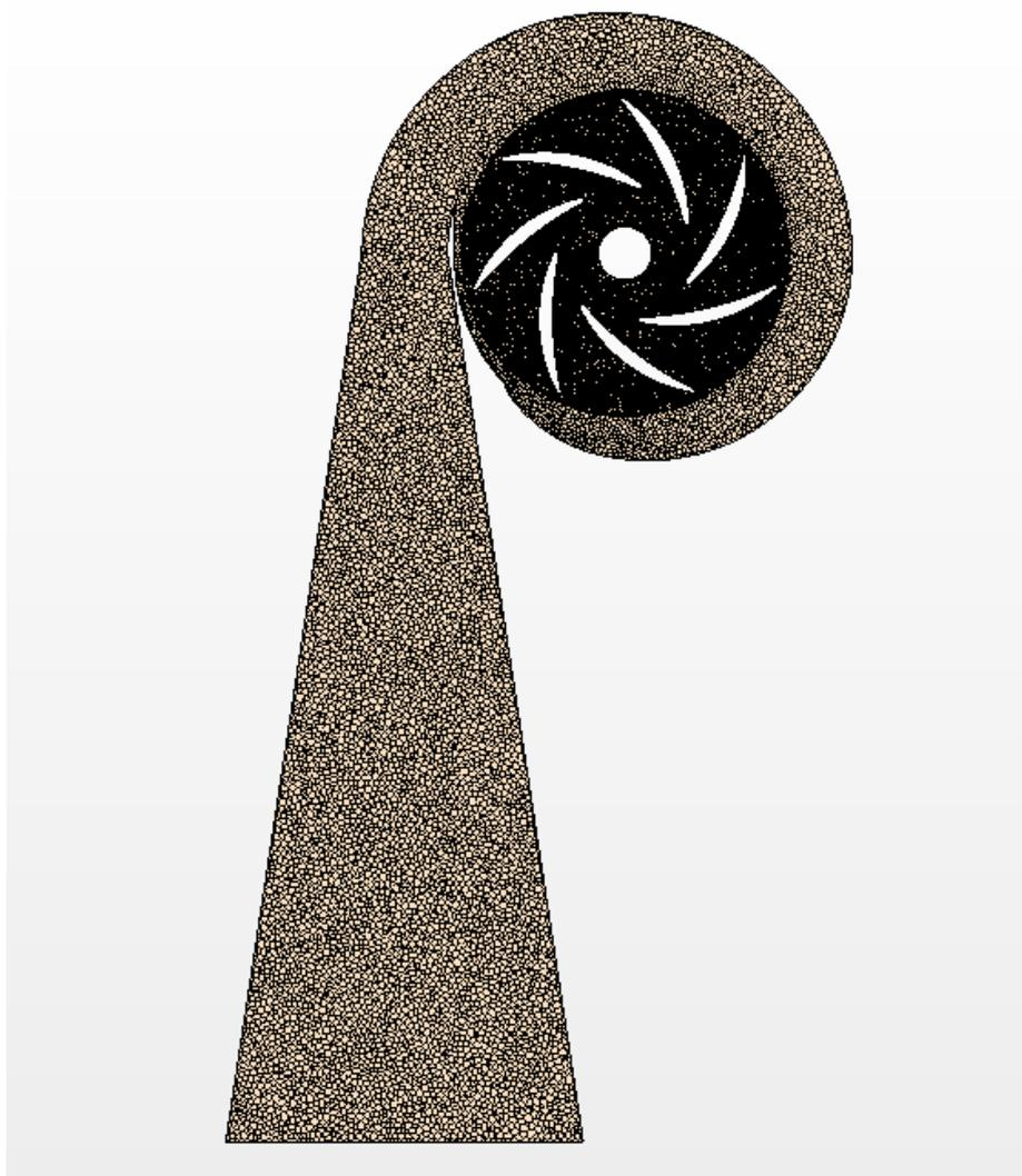
*Figura 42. Vista del mallado en corte 2.*
