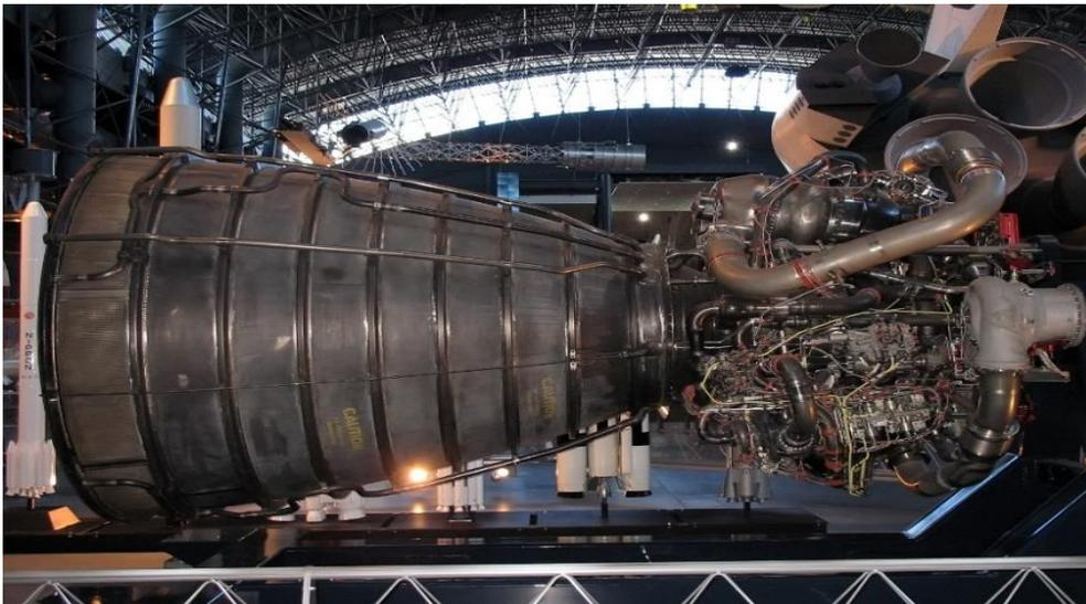
*Figura 5. Motor RS-25 del Space Shuttle.*
