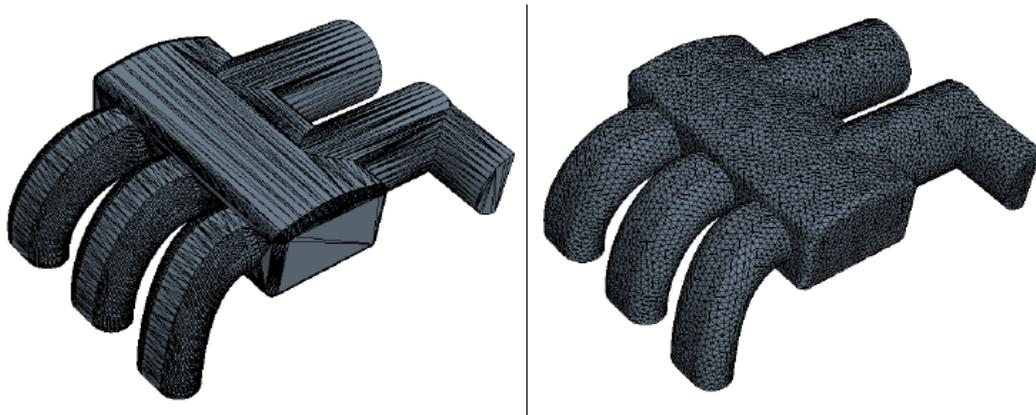
Figura 40. Comparación de una malla usando o no la opción surface remesher.
