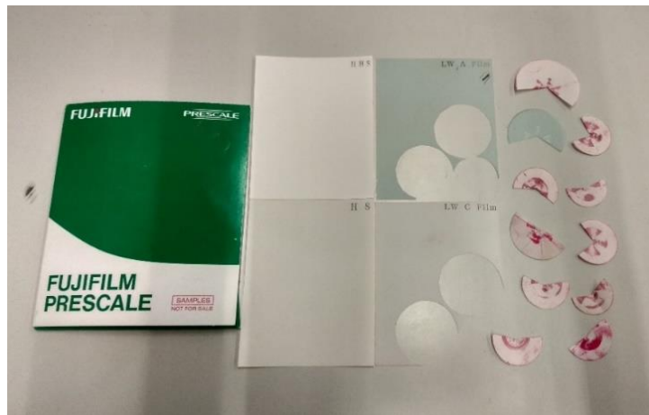
Figura 18. Papel de presión "Fujifilm Prescale"
