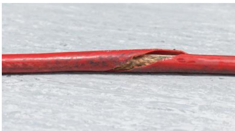
Figura 10. Defecto de aislamiento en conductor de cobre (Fuente: [www.structuralia.com](http://www.structuralia.com))
