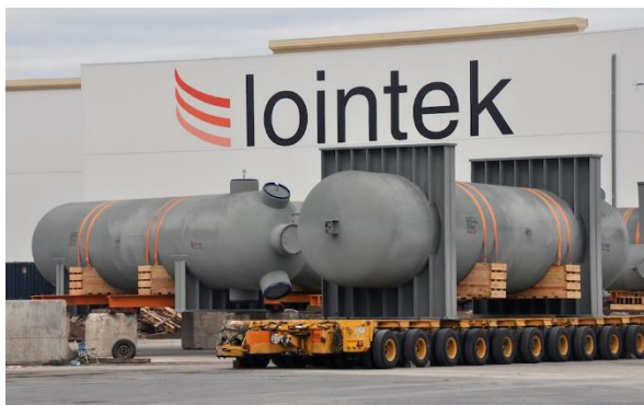
Irudia 2 Energia sorkuntza planta bateko bero trukagailuak.
