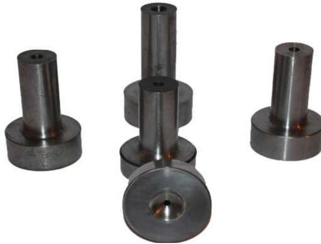
*Imagen 7. Boquillas de inyección.*
