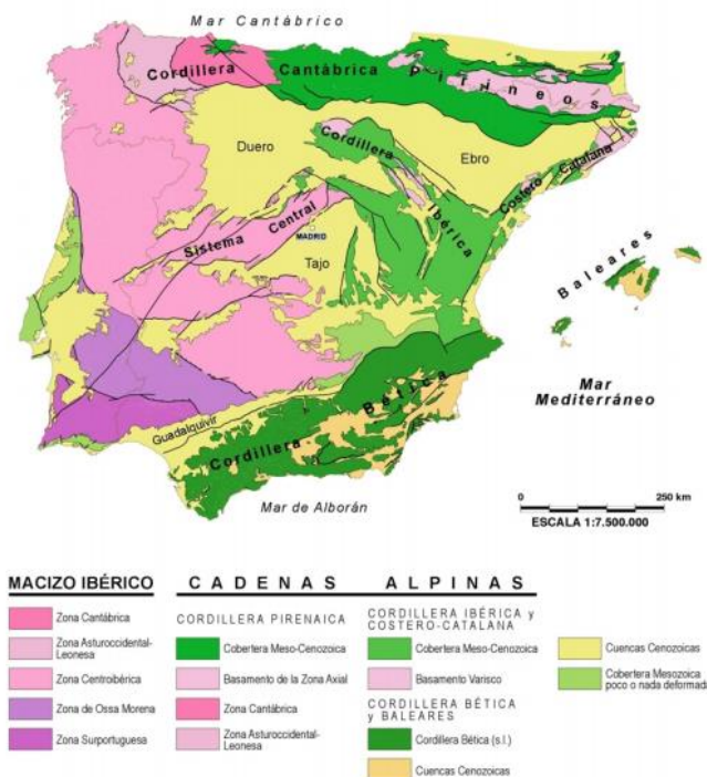
Fig. 1. Principales unidades geológicas de España. Se señala en rojo la zona de actuación exagerándola para su mayor claridad.
