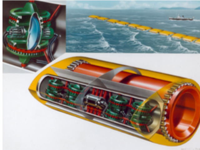
Figura 1.6-14. Versión del Duck de 1979 equipada con giroscopios.
