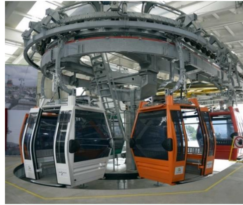
Ilustración 5. Teleférico de movimiento reversible (izquierda) y unidireccional (derecha)
