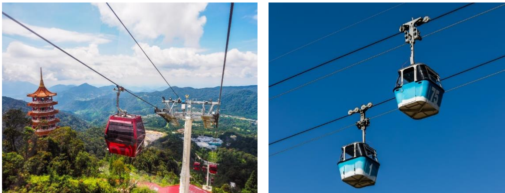
Ilustración 4. Teleférico monocable (izquierda) y bicable (derecha)
