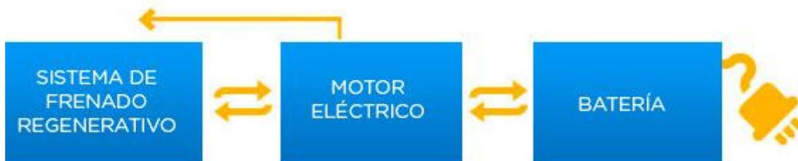
*Ilustración 8. Esquema de la alimentación y funcionamiento de un BEV. Fuente: IBIL*
