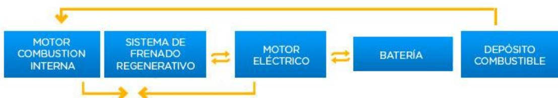
Ilustración 10. Esquema de la alimentación y funcionamiento de un HEV. Fuente: IBIL
