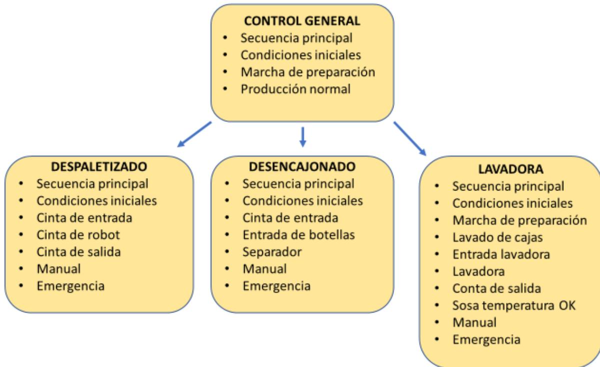
Fig. 80 Esquema de todos los Grafcets
