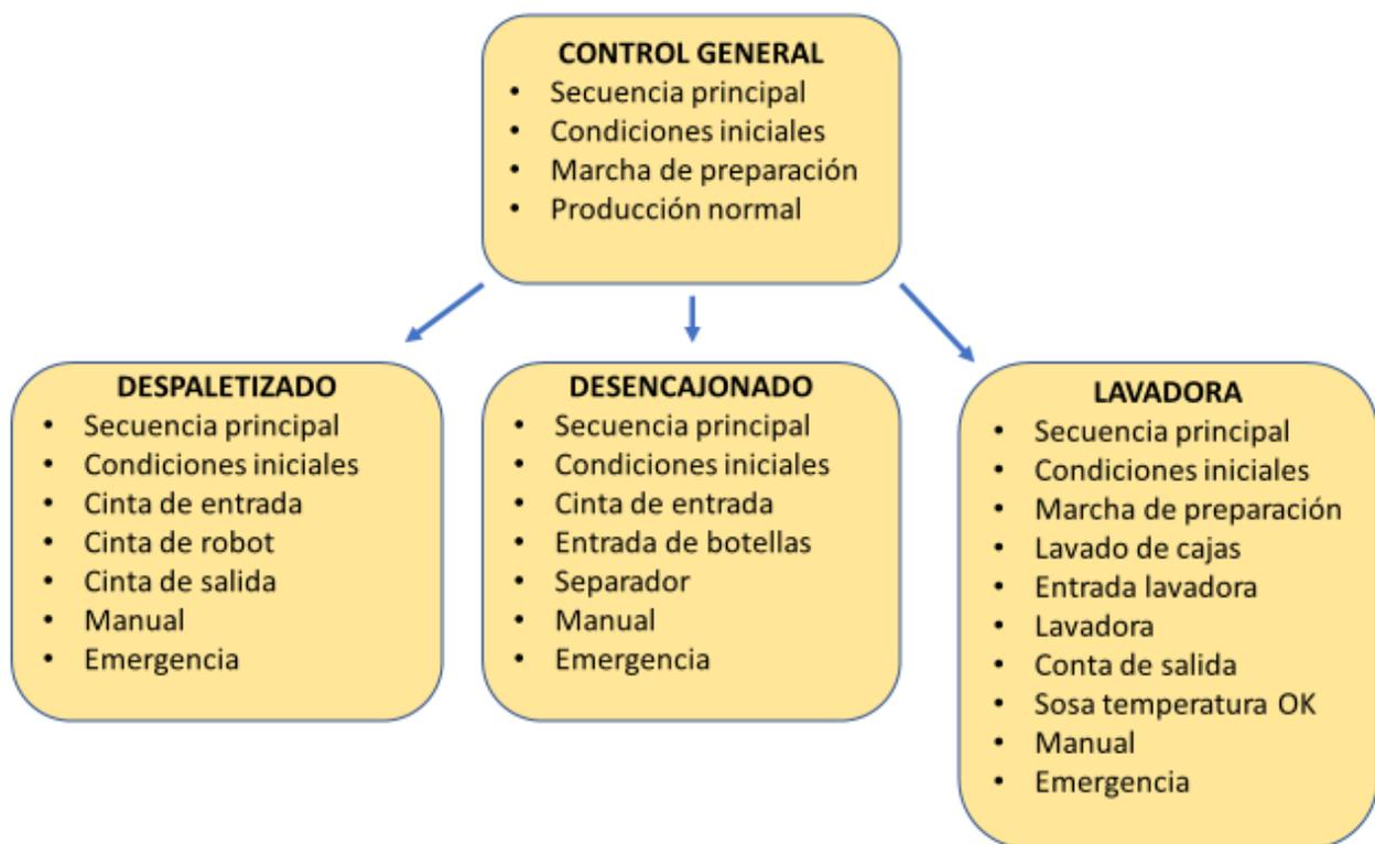
Fig. 21 Esquema general de la programación
