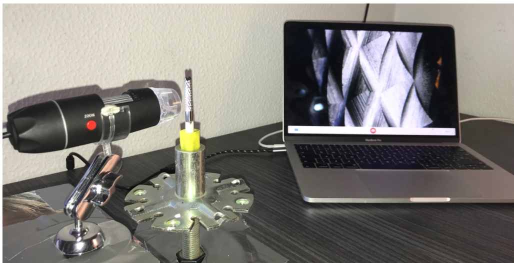
Ilustración 38: Instalación completa de análisis de desgaste
