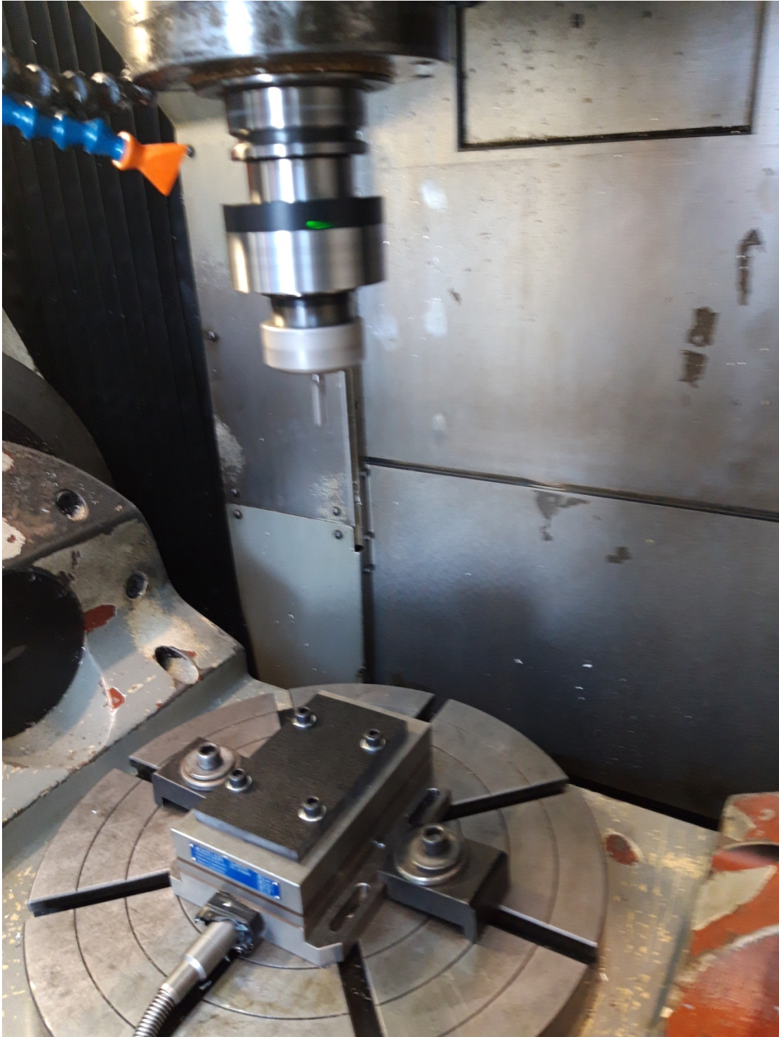
Ilustración 50: Sistema completo. Probeta carbono, portaherramientas Spyke y mesa Kistler
