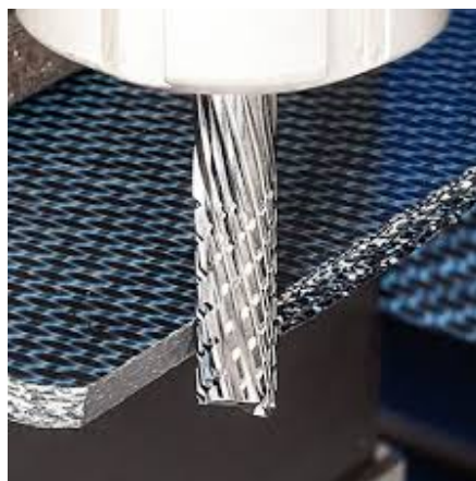
Ilustración 9: Fresa multidiente recantando CFRP
