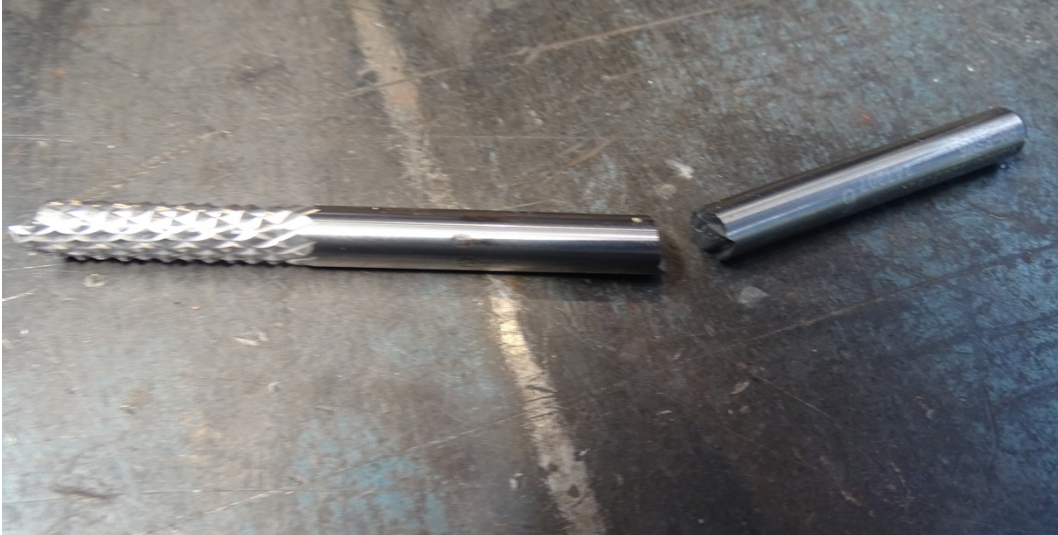
Ilustración 61: Herramienta Kendu rota en la prueba de macizado
