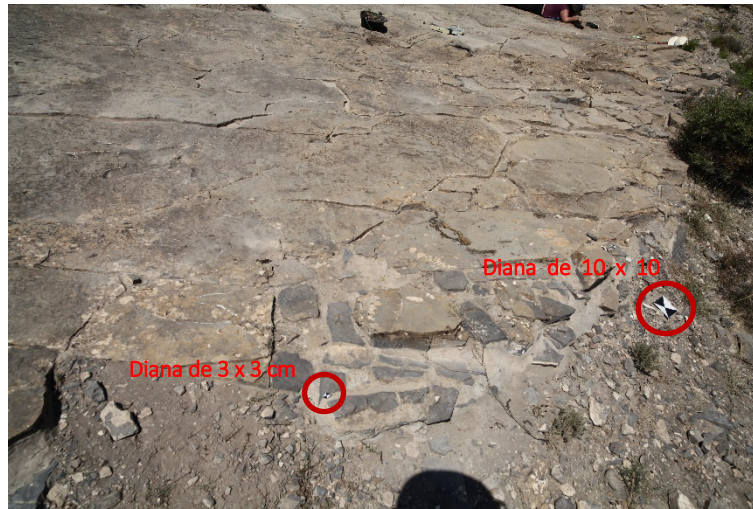
Fig. 4. Señalización mediante dianas para la orientación de los modelos fotogramétricos de Las Navillas.
