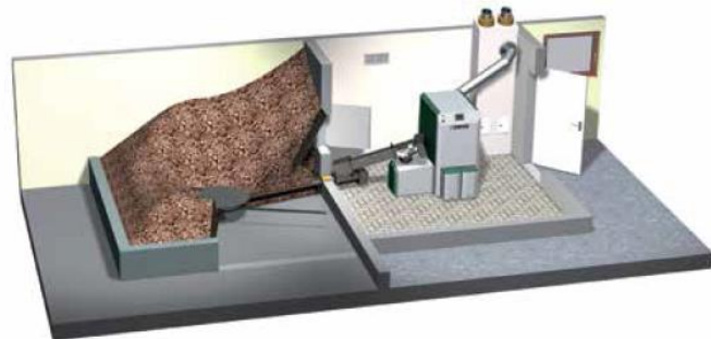
Alimentación mediante agitador rotativo horizontal con tornillo sinfín ascendente para un óptimo aprovechamiento del almacén.
