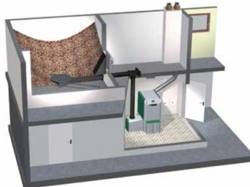
Almacén de combustible y sala de calderas a distintos niveles. Descarga horizontal mediante agitador rotativo y tubo de caída.
