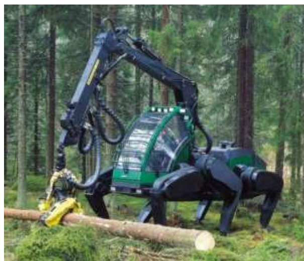
Ilustración 2.2. Robot andante con aplicación en la silvicultura.
