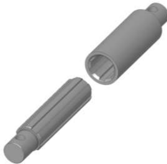
Ilustración 7.30. Acoplamiento que consta de eje estriado y forro.
