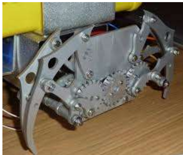
Ilustración 2.5. Ejemplo de aplicación de mecanismos andantes en tareas submarinas.
