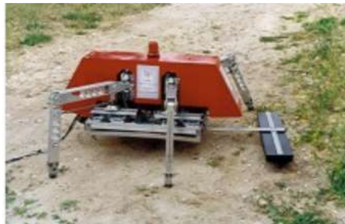
Ilustración 2.4. Sistema de locomoción utilizado para retirar minas.
