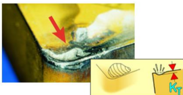
ILUSTRACIÓN 35- DESGASTE DE CRÁTER (COROMANT, INTEREMPRESAS, 2017)
