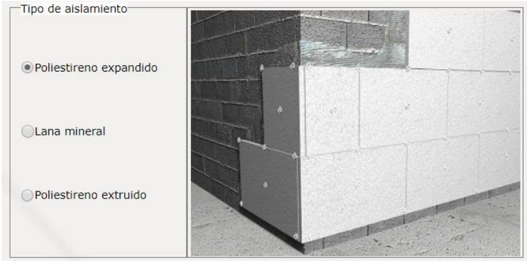
**Ilustración 31:** Tipo de aislamiento empleado en la mejora de la envolvente térmica
