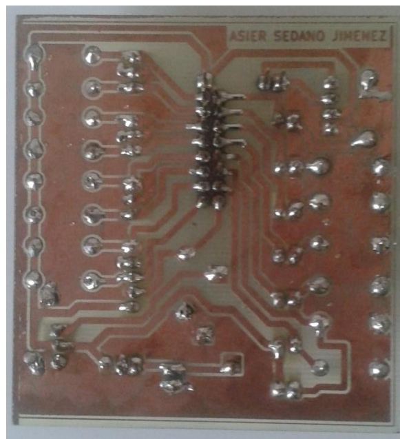
Figura 4.79 Placa PCB soldada, capa inferior.
