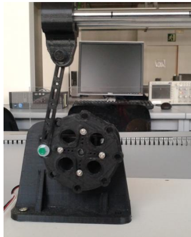
Figura 4.36 Barra en equilibrio, ángulo de giro del servo a 90^\circ , OCR5A = 1400 .
