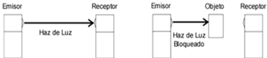
Figura 3.14 Modo de trabajo de los sensores ópticos llamados como modo barrera.
