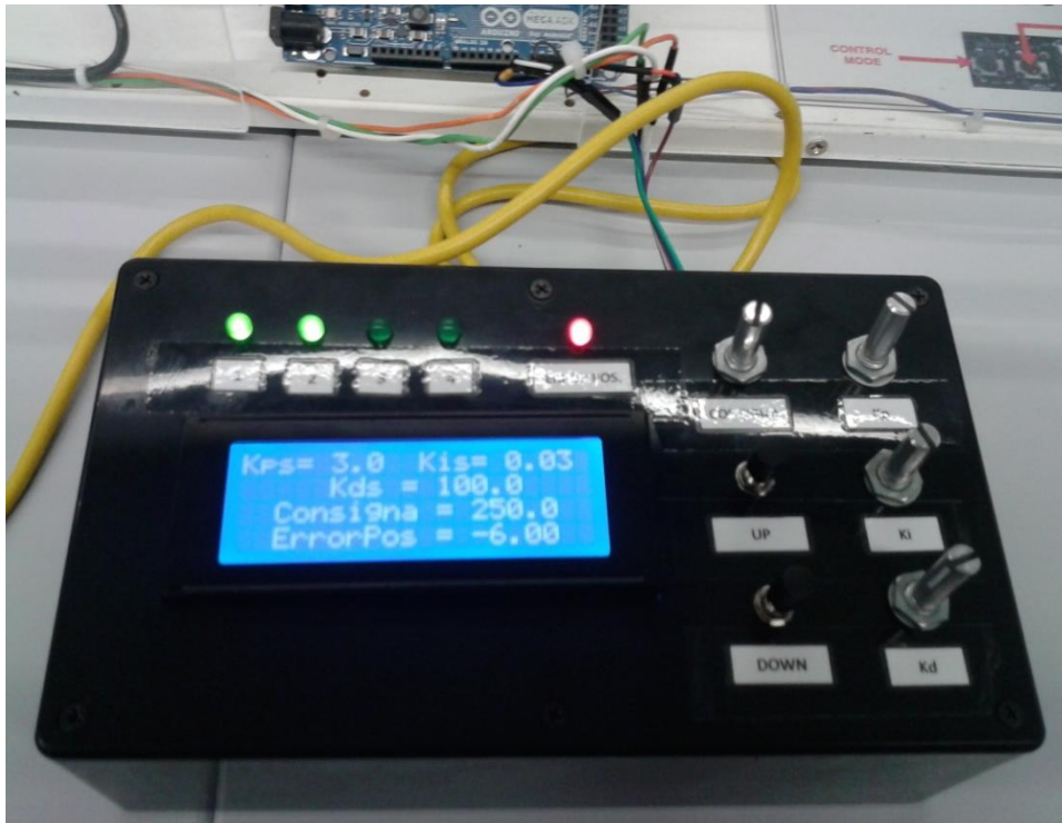
Figura 4.85 Interfaz de usuario implementada en el sistema.
