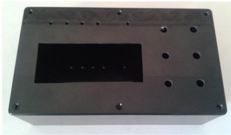
Figura 4.80 Realización de los agujeros en la tapa de la caja.
