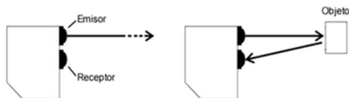
Figura 3.13 Modo de trabajo de un sensor óptico o infrarrojo.
