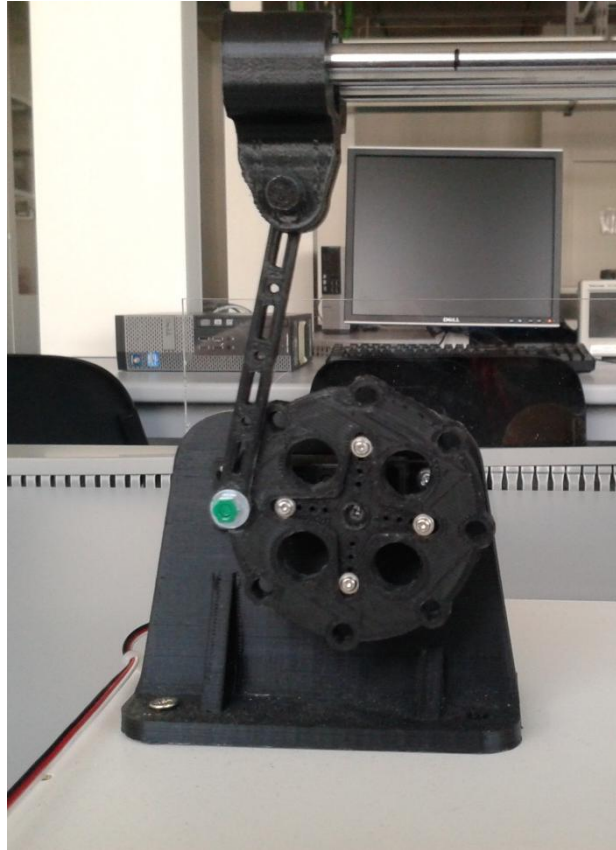
Figura 4.19 Ángulo de giro del servomotor a 90^\circ , sitúa la barra en horizontal; OCR5A = 1400 .
