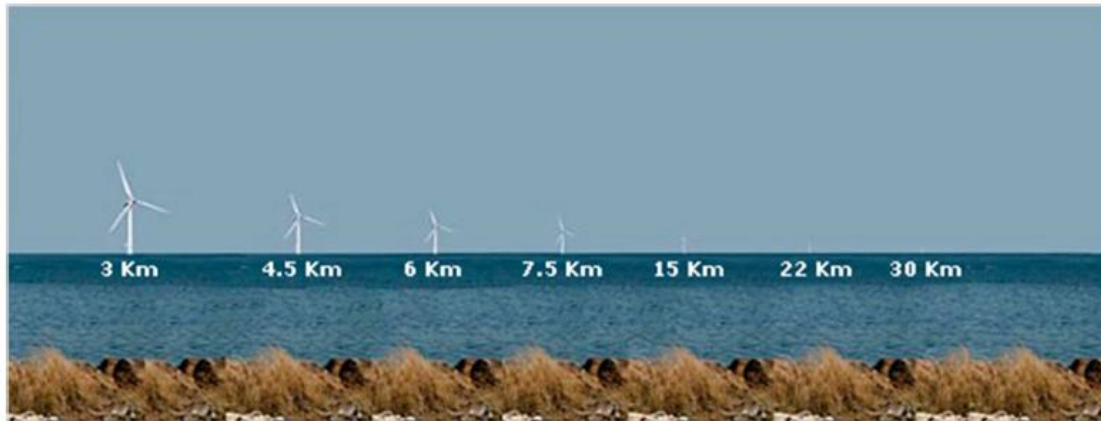
Ilustración 26 Impacto visual aerogeneradores (Fuente: Iberdrola)
