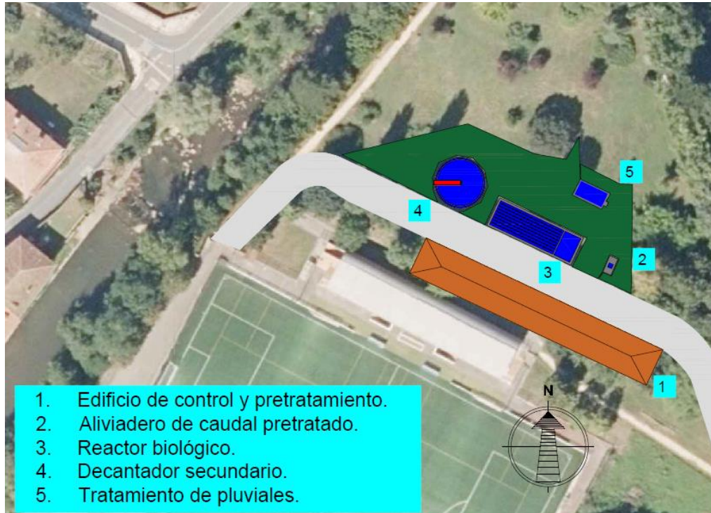
Figura 36: Planta de la EDAR de Orozko. (Propia)
