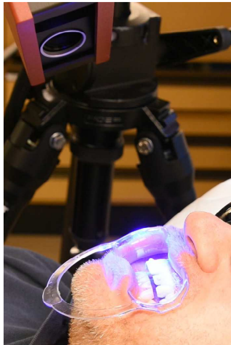
2-37. irudia: ATOS eskanerrarekin esfera erdiak itsatsita dituen hortz-uztaiaren eskaneatze prozesua
