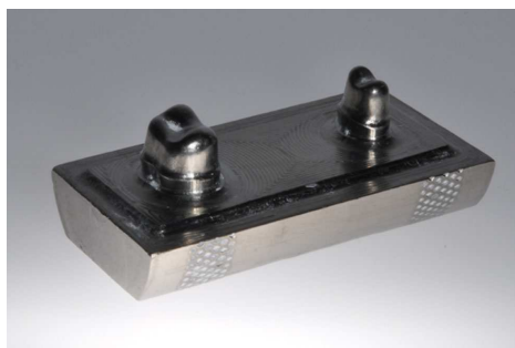
2-25. irudia: Eskanerren zehaztasuna aztertzeko prestaturiko titaniozko modeloa [114]
