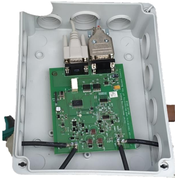
Figura 5. PCB del sensor con comunicaciones mediante RS485
