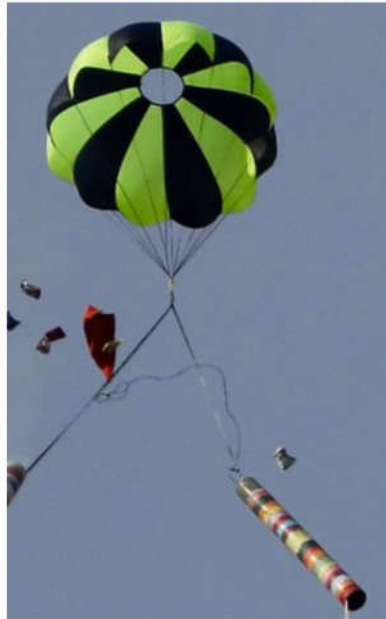
Figura 16: Sistema de recuperación basado en paracaídas
