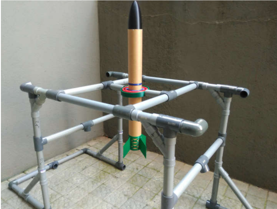
Figura 36: Estación de pruebas con el modelo de cohete instalado
