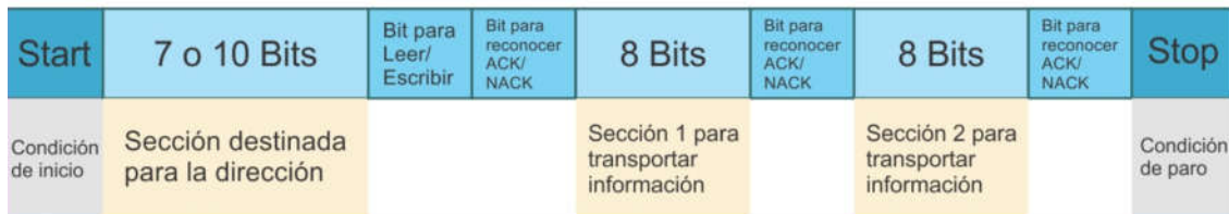
Figura 21: Composición de mensaje en el protocolo I2C
