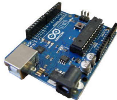
Figura 24: Placa de prototipado Arduino con microcontrolador ATMEGA328p
