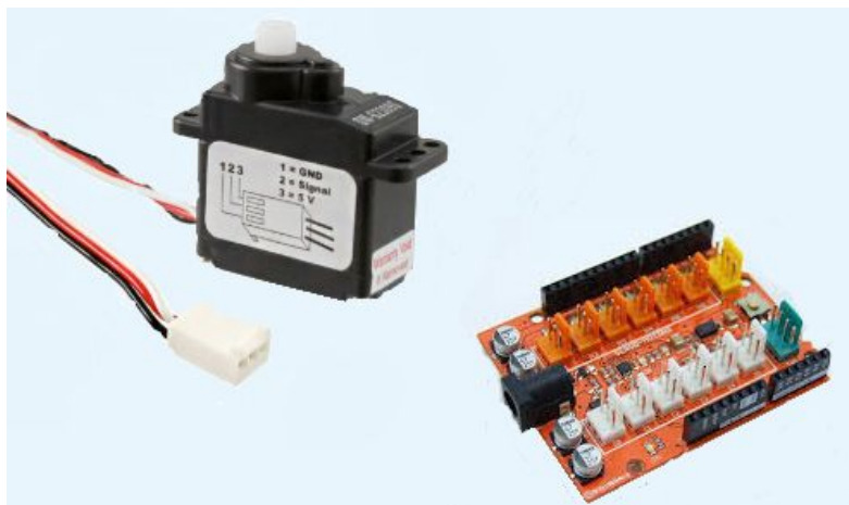
Figura 2: Servomotor y shield para TinkerKit Braccio
