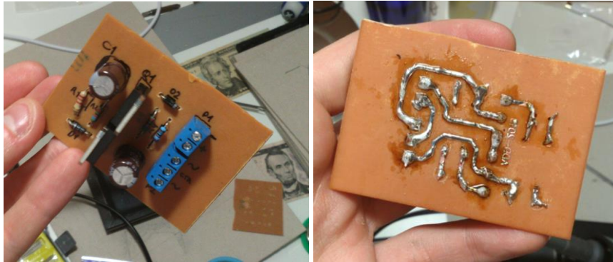
Fig. 5.5.16. Componentes montados (izquierda) y circuito de potencia reforzado con estaño (derecha)
