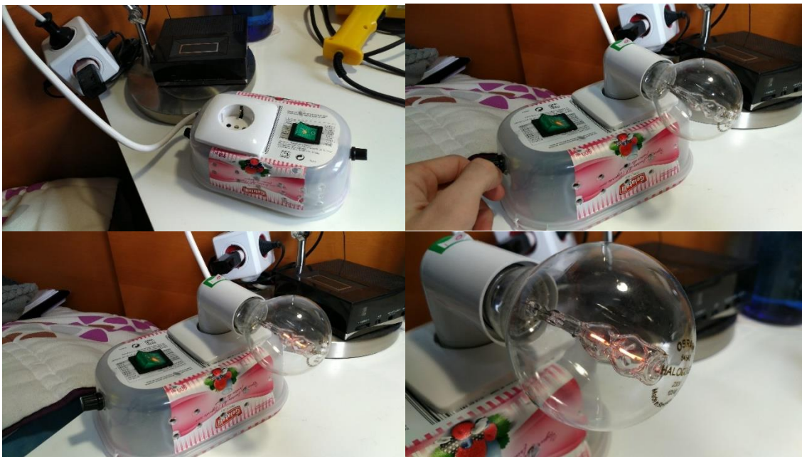
Fig. 5.7.6. Regulador AC en funcionamiento, regulando el filamento de una bombilla de 100W
