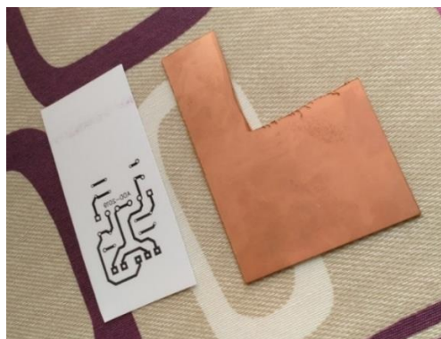
Fig. 5.5.13. Circuito impreso en papel fotográfico a laser y placa de cobre
