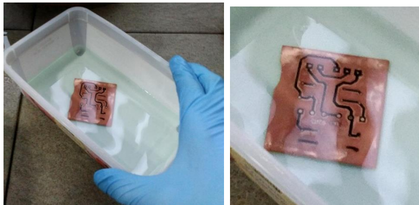
Fig. 5.5.14. Disolviendo cobre con ácido
