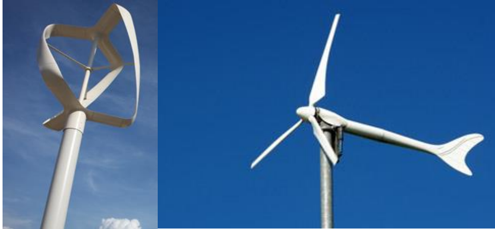
Irudia 22 Ardatz bertikalezko eta horizontalezko energia minieolikoko aerosorgailua
