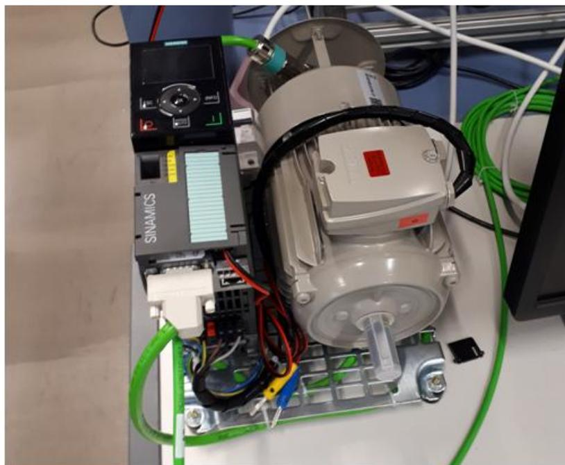
Ilustración 6. Variador de frecuencia y motor empleados en las pruebas
