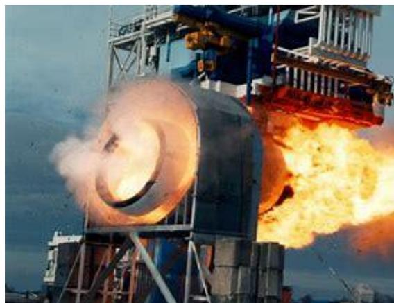
Ilustración 3. Prueba destructiva del motor aeronáutico General Electric GE90
