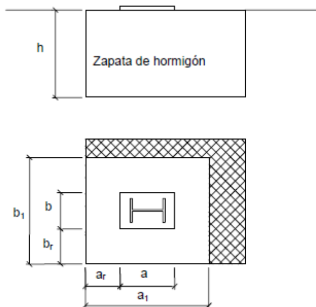
41. Irudia: Ainguraketa plaken dimentsionaketarako eskema. (Iturria: CTE)
