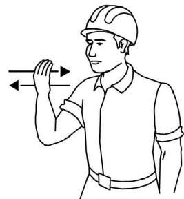
12 AVANZAR EN LA DIRECCION INDICADA POR EL SEÑALISTA
