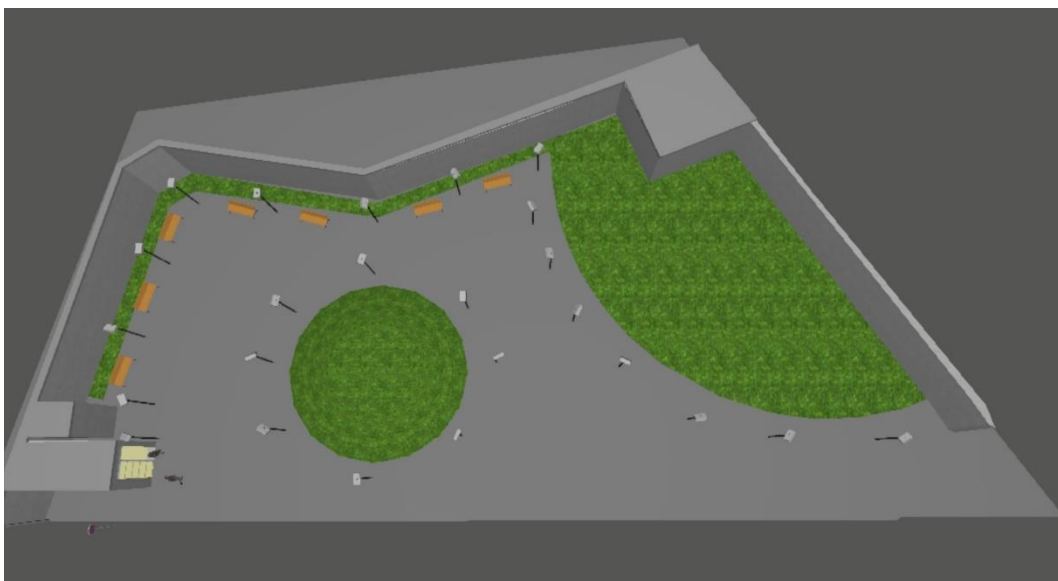
Figura 36. Disposición de las luminarias de exterior.
