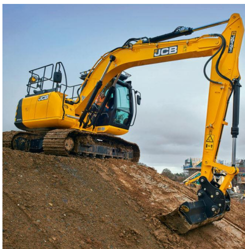
Figura 3. Retroexcavadora de orugas
