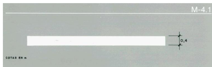
Figura 6. Línea transversal de detención
