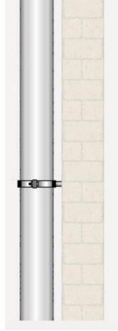
Imagen 37. Bajante en el exterior del edificio para aguas pluviales. Fuente: Generador de precios Cype
