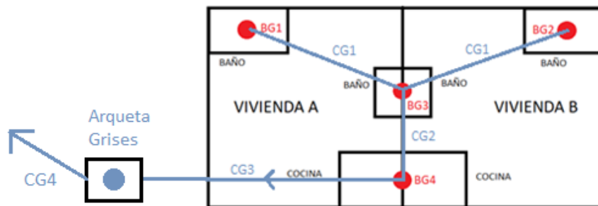
Imagen 22. Vista en planta de la red de aguas grises. Fuente: Elaboración propia.
