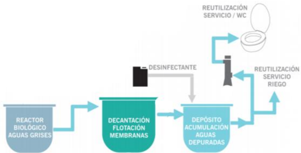
Imagen 11. Esquema del tratamiento físico-biológico. Fuente: Aqua España.
