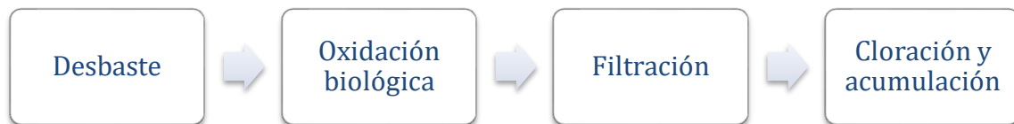
Figura 6. Etapas del funcionamiento. Fuente: Elaboración propia.
