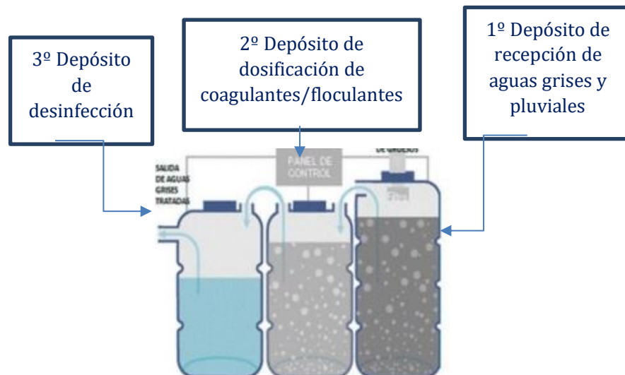
Imagen 15. Equipo de reutilización de aguas grises con tratamiento físico-químico. Fuente: Inter empresas.
