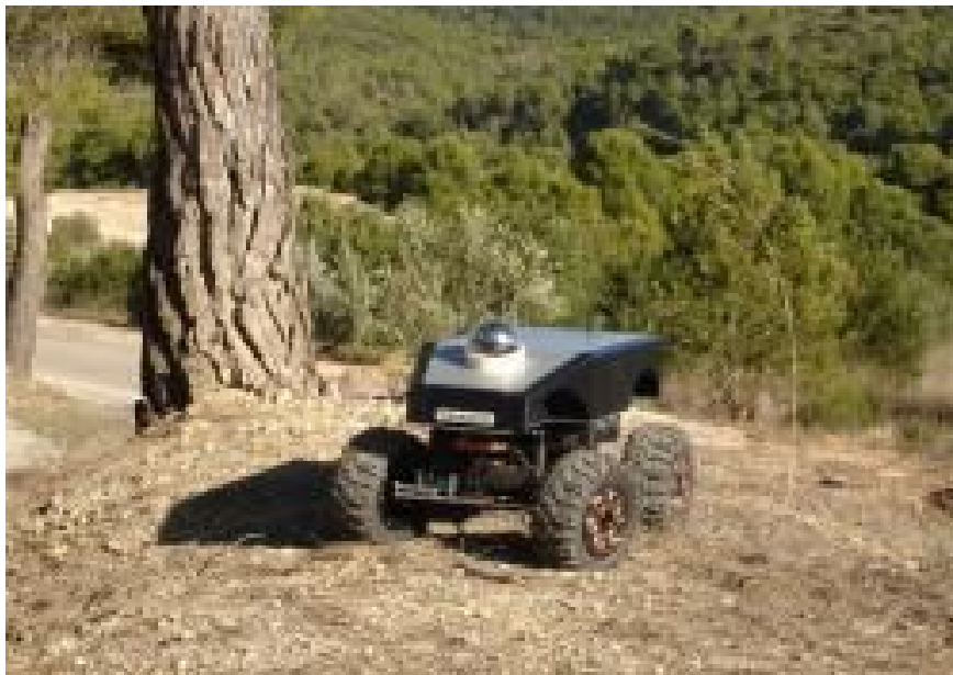
Ilustración 2: robot móvil Summit, de Robotnik, navegando por un terreno irregular
