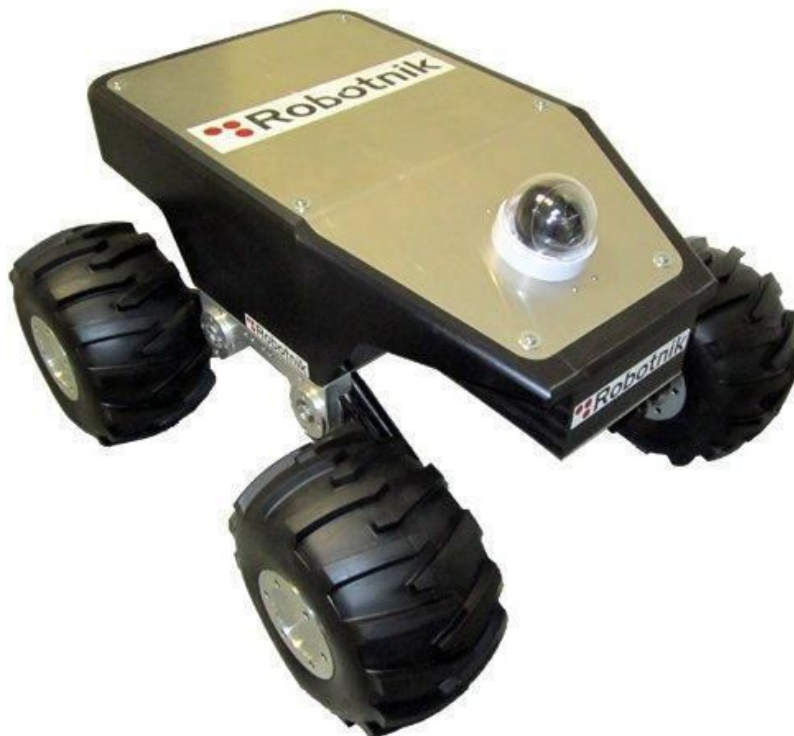
Ilustración 1: robot móvil Summit, de Robotnik
