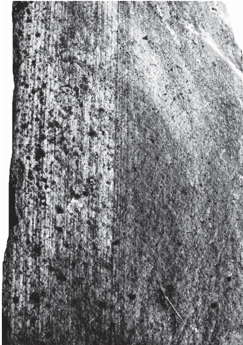
FIGURA 3. Estructura laminar de la roca con una gran mancha de difusión hematítica
