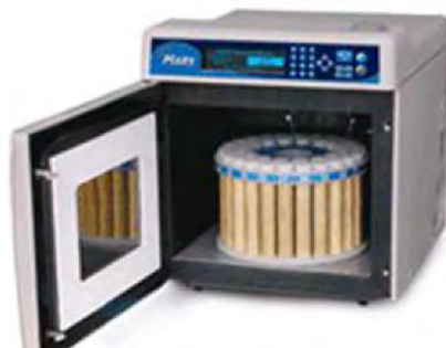
Figura A.3. Microondas CEM MARS 5 empleado en la síntesis asistida por microondas, junto con teflones en su interior.
