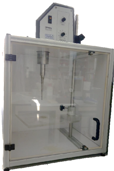
Figura A.1. Aparato de ultrasonidos en el que se está llevando a cabo una síntesis asistida por ultrasonidos.
