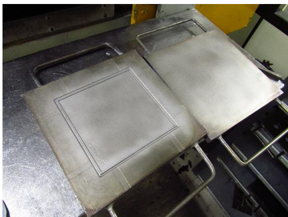
25.- Irudia. Ezkerreko irudian kautxua kokatzen deneko plakak ikus daitezke. Eskuineko irudian ezkerreko plakak sartzeko eta probetak lortzeko erabiltzen den prentsa ageri da.
