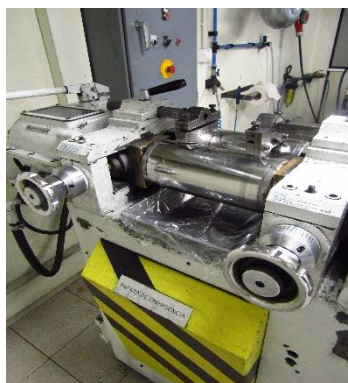
24.- Irudia. Kautxu nahasteari itsaspenaren aurkako produktua kentzeko erabiltzen den zilindroa.
