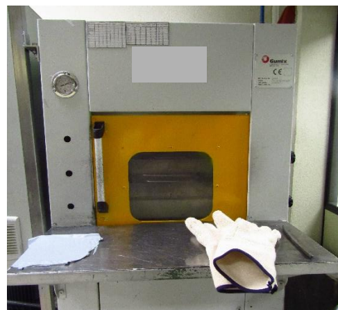
25.- Irudia. Ezkerreko irudian kautxua kokatzen deneko plakak ikus daitezke. Eskuineko irudian ezkerreko plakak sartzeko eta probetak lortzeko erabiltzen den prentsa ageri da.
