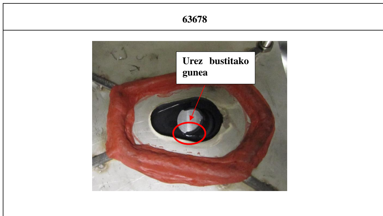
54.- Irudia. 63678 eskaintzako norabide hauts babeslea water submersion saiakuntzan eskaintako emaitza kualitatiboa, urez bustitako gune batekin.
