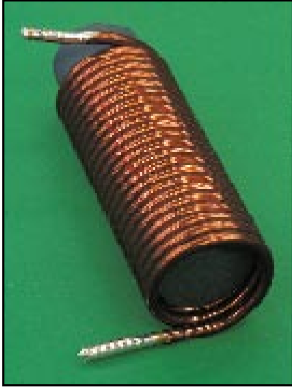
2. irudia. Ereku magnetikoa sortzeko biribilkaturiko Cu-zko hariak osatzen du solenoidea edo harila.
