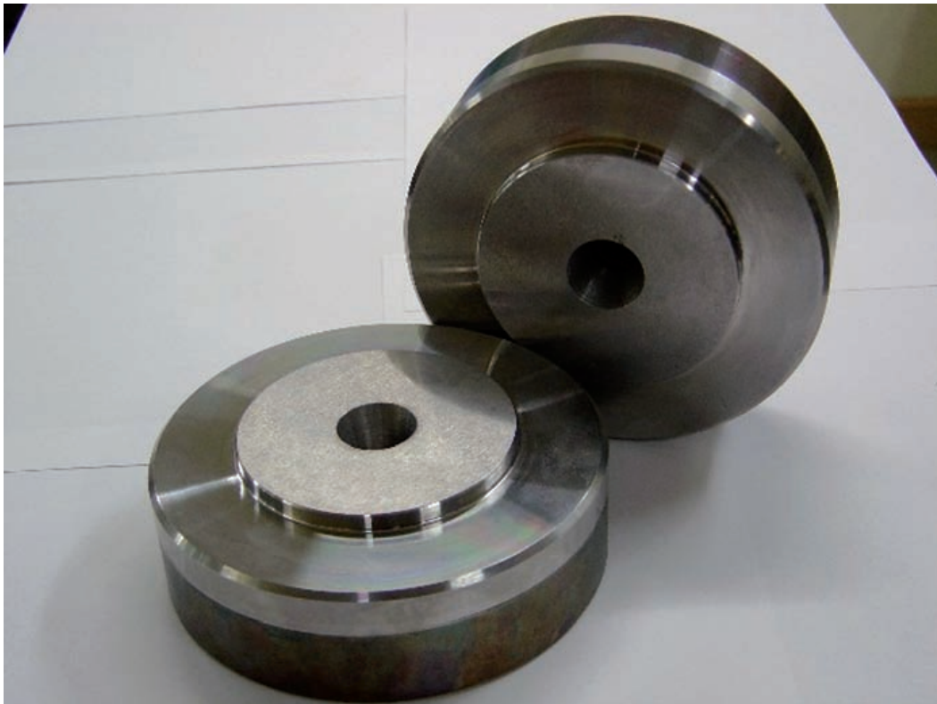
2. irudia. Harizko elektrohigaduraz mekanizatutako piezak
