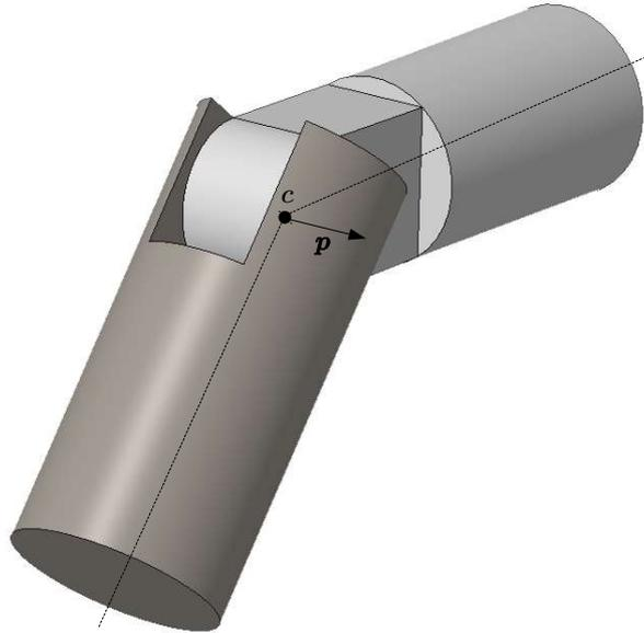
Figura 6.2: Representación de un par de rotación.
