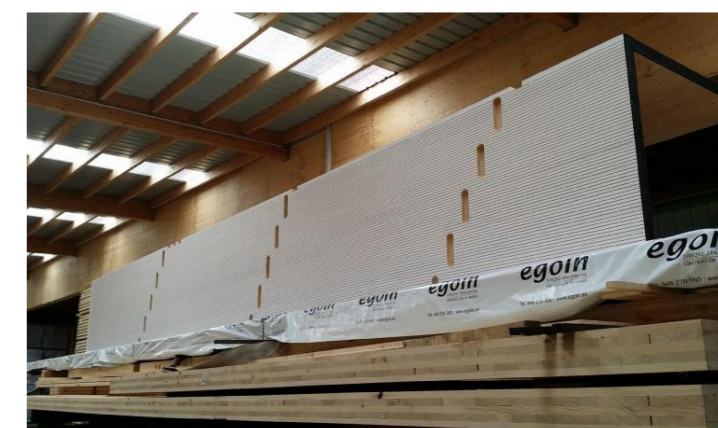
2. Panelen eta egitura elementuen antolamendua garraiorako.
