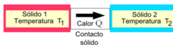
Figura 49 Transmisión de calor por conducción
