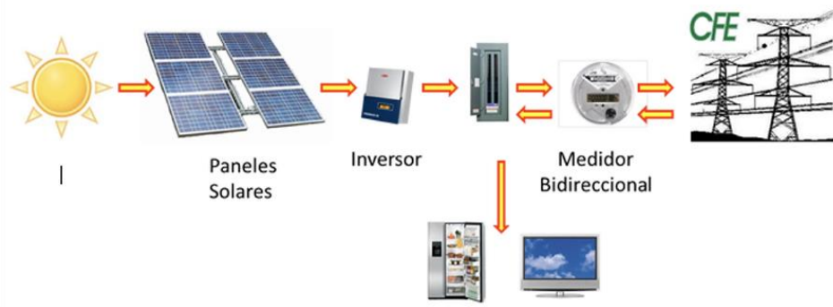
IMAGEN 23: Sistema fotovoltaico conectado a red
